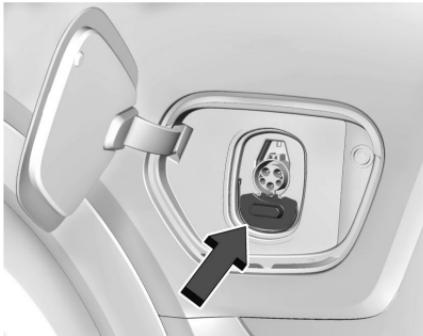
3. Desasegure la cubierta para polvo de carga CD y bájela completamente.
