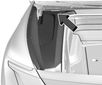
2. El Bloque de fusibles del compartimiento debajo del cofre está debajo de una cubierta y una extensión/protección lateral en el compartimiento debajo del cofre. Retire el protector, comenzando por la parte superior. Una vez que los sujetadores se desconectan, las lengüetas a lo largo de la parte inferior se pueden desconectar para retirar la cubierta de acceso del lado izquierdo.
