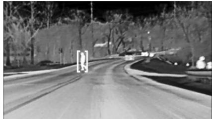
Con el sistema de Frenado delantero de peatones activado, la Visión nocturna proporciona una alerta roja en la Pantalla transparente (HUD), si está equipado, cuando el sistema detecta que el vehículo se está acercando muy rápido a un peatón o animal grande. Además, una alerta emite un pitido o el Asiento de alerta de seguridad pulsa, si está equipado. Consulte *Sistema de frenado ante peatón al frente (FPB)* ▷ 282.
