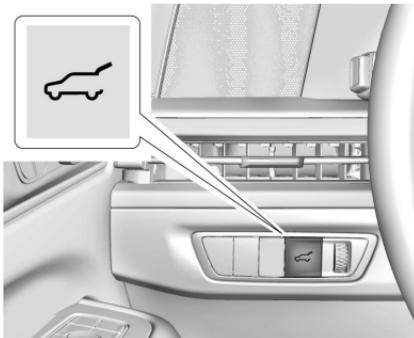
La puerta trasera eléctrica se opera a través de un interruptor junto al volante, y se puede ajustar a través de la pantalla de inicio de infoentretenimiento. El vehículo debe estar en P (estacionamiento).
