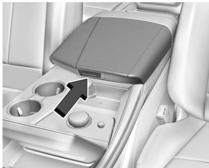
Presione el botón y levante para abrir. Hay un conector auxiliar, puertos USB, y un tomacorriente para accesorios. Vea *Norma de Radiofrecuencia* ▷ 410.
