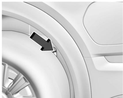
2. Jale la manija de liberación del cable de carga manual de emergencia. El cable de carga CD se liberará.
