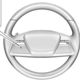
➊ : Presione para prender o apagar el volante de dirección con calefacción. Se ilumina un indicador junto al botón cuando la función está encendida.
