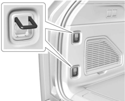
Hay cuatro amarres de carga en el área de carga trasera y cuatro en el compartimiento debajo del cofre, que se puede usar para asegurar la carga y evitar que se mueva dentro del vehículo.
