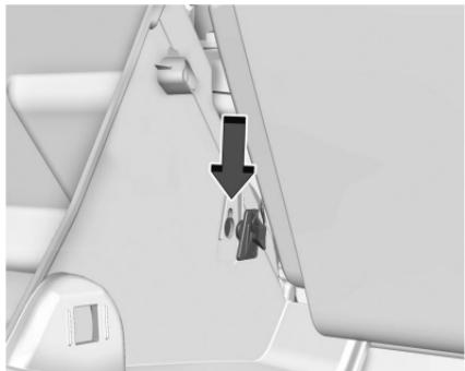
3. Desconecte el amortiguador de cadena para retirar completamente la bandeja de la guantera.
