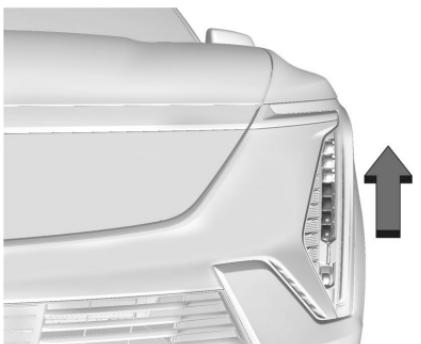
La barra del indicador de estado de carga de los faros está ubicada en los faros. A medida que se realiza la carga, las barras de luz azul de los faros se llenan hacia la parte superior del vehículo.
