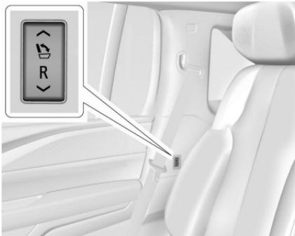
Para ajustar los asientos de la segunda fila con el interruptor del tablero trasero:
