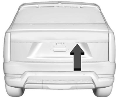
Si está equipado, presione el botón sobre la matrícula para abrir el cristal de la puerta trasera, o presione
